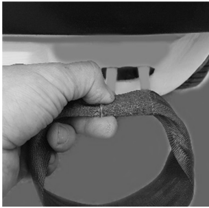
1 - Gurt doppelt legen - offene Seite Richtung Fahrzeug
