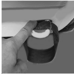
2 - Gurt doppelt über Abschlepp-Öse legen
