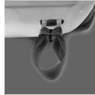
6 - Kabelbinder festziehen, Ende abschneiden
